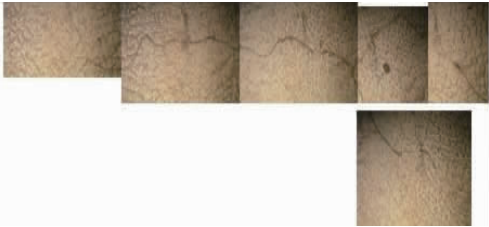
图 7 5 号缺陷沿长度方向的金相拼图
