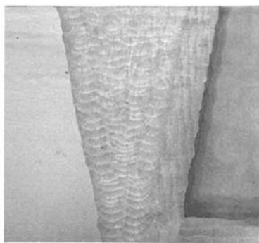
图 2 焊缝宏观组织
