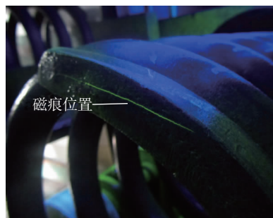
图 3 端圈端面淬火裂纹的磁痕显示
