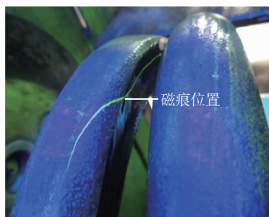
图 4 端圈上端面淬火裂纹的磁痕显示
