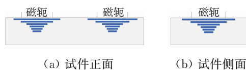
图2 环绕磁轭分布的感生涡流
