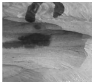
图7 尿素合成塔衬 里层泄漏
