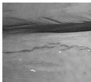
图4 内衬热影响 区腐蚀裂纹
