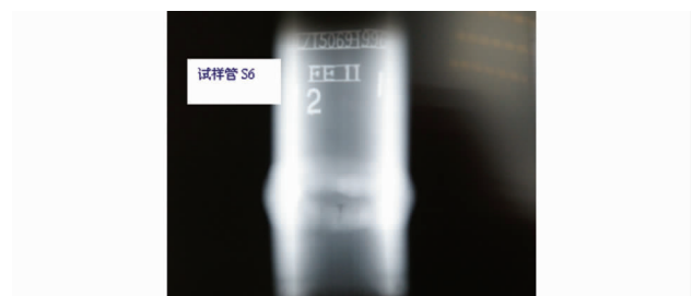
(a) 横向裂纹及气孔射线底片
