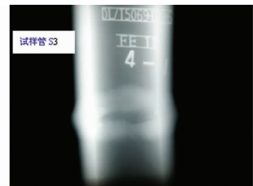
(a) 未焊透射线底片
