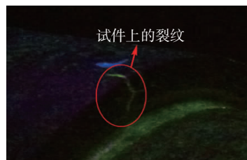
图 8 轴套渗透检测裂纹示意图
