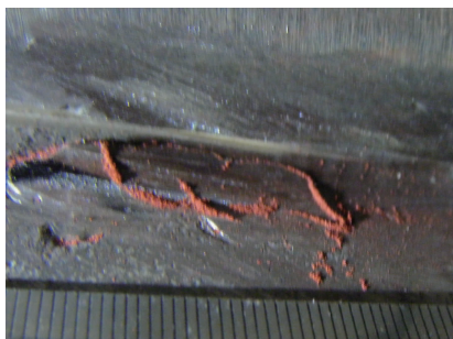
图 7 FCAW-2F,焊脚高度不够,应力
