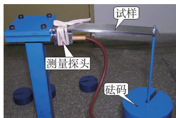
图1 悬臂梁应力加载试验
