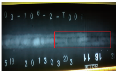
图3 某原油管道 \phi 813 \text{ mm} \times 9.5 \text{ mm} 内咬边缺陷影像
