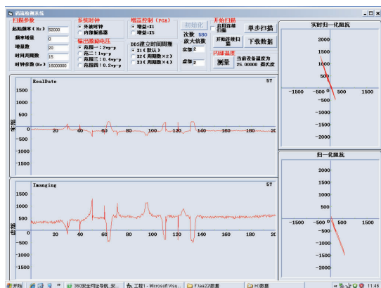
图 5 钢板连续扫描(52 kHz)
