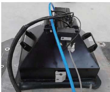
图7 复合材料无损检测仪
