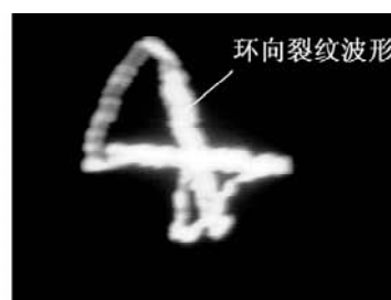
图6 2号裂纹显示的波形
