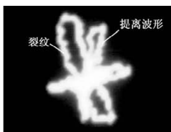
图5 1号裂纹显示的波形
