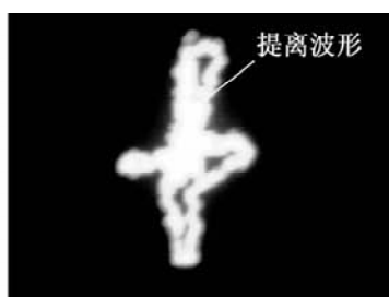
图4 无缺陷显示的提离波形
