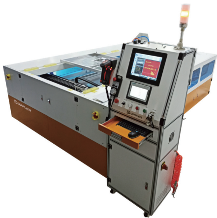
图 1 动力电池涂胶粘接质量相控阵超声检测系统
