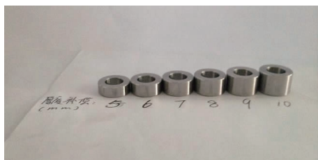
图3 管子-管板焊缝射线透照补偿块外观图片
