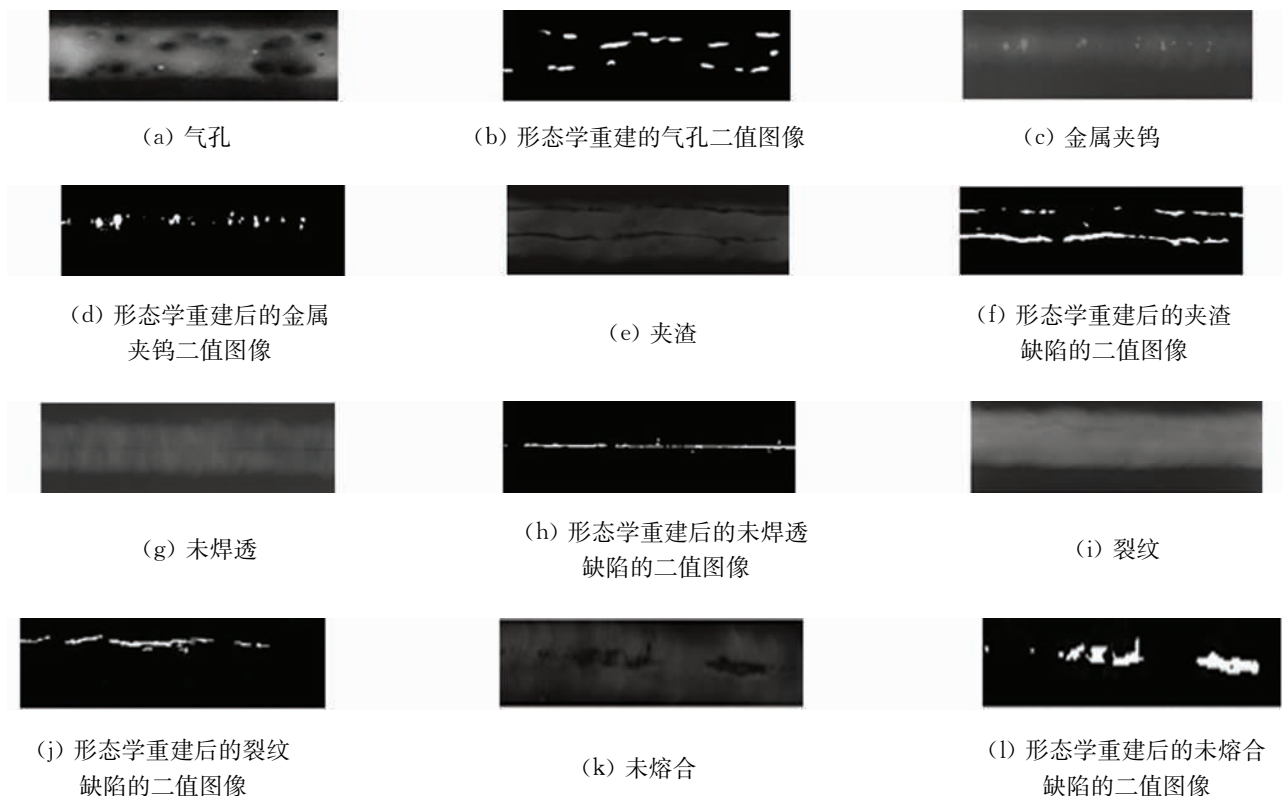
图 2 X-Ray 缺陷原始图像和数学形态学重建后图像
