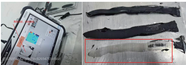
图 7 试样 4 的视频超声检测结果与实物对比
