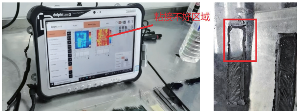
图 5 试样 2 缺陷的视频超声检测结果与实物对比
