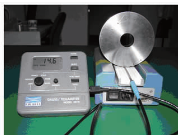
图 1 测量环孔表面磁场的装置
