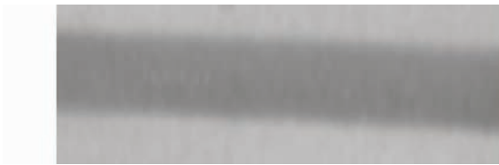
图 5 由低通滤波获取的焊缝背景图像
