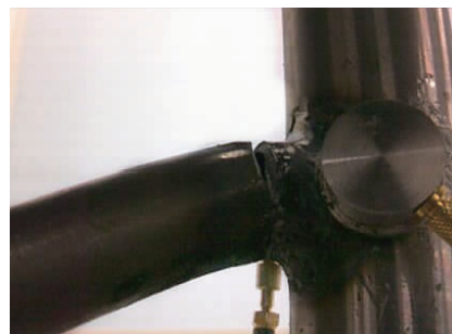
图 3 传感器布置及试件断裂实物图
