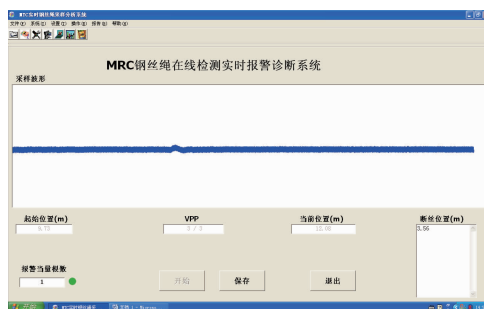
图 9 1 号机滚筒端钢丝绳检测时实时显示波形
