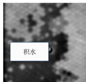
图 15 积水的红外热像检测原始热图
