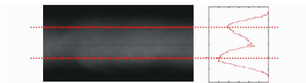
图 3 第一特征向量的分布以及相应的图像垂直方向的灰度变化
