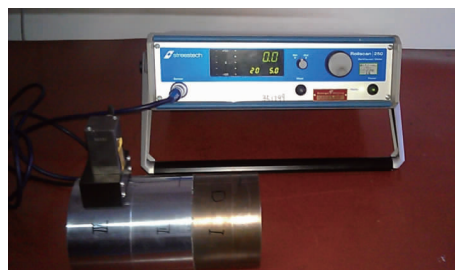
图3 测试仪器、探头和参考试样
