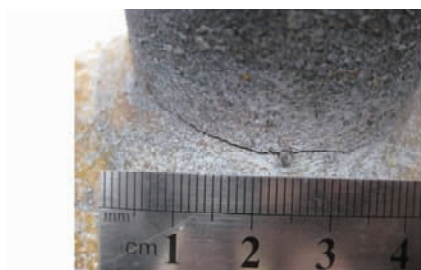
图7 某新建电厂过热器联箱接管侧热影响区裂纹
