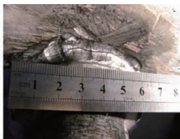
图5 某新建电厂汽包插管角焊缝裂纹
