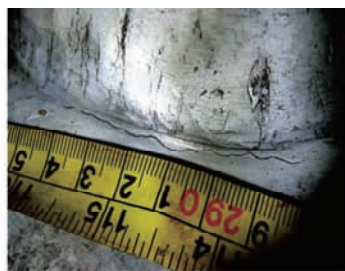
图6 某电厂在役减温器联箱侧角焊缝裂纹
