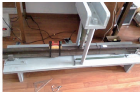
图4 钢轨应力加载示意图
