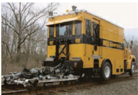
图1 集成超声与磁感应技术的轨道巡检车 [6]
