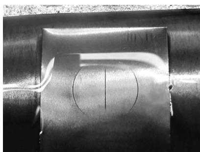
图3 灵敏度验证后的磁痕显示
