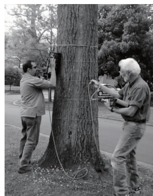
图5 树木雷达扫描现场工作照片
