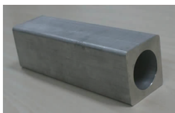
图2 不锈钢套管试件
