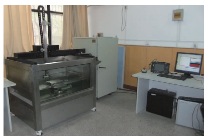
图5 水浸超声试验系统
