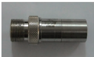
图6 常规水浸超声探头
