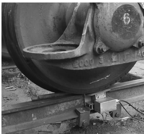
图 14 轮对踏面电磁超声检测系统实物图
