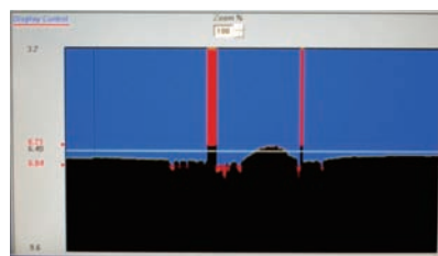
图 1 焊缝及热影响区 B 扫描图像
