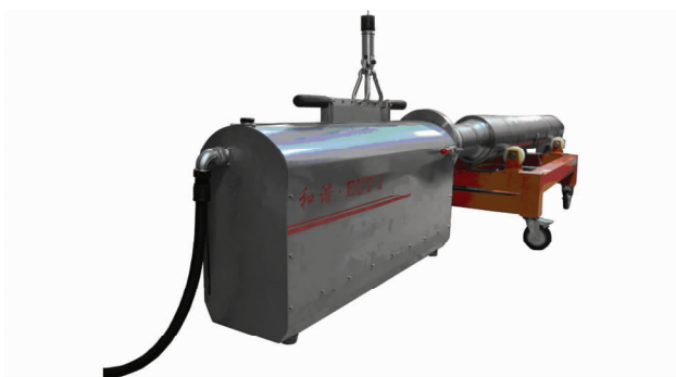
图1 大直径空心轴类超声探伤系统
