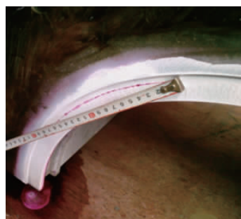
图 3 渗透检测线性缺陷显示
