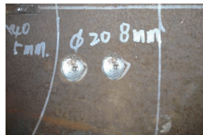
图 5 存在缺陷的实体管道
