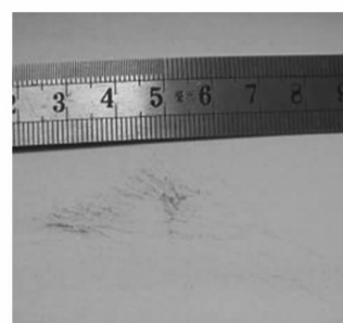
图 6 内衬层背侧小裂纹区域
