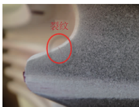
图7 拆卸打磨处理后的裂纹显示
