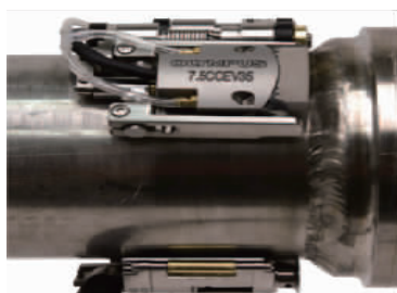
(b) 使用单侧探头检测管与法兰连接部位
