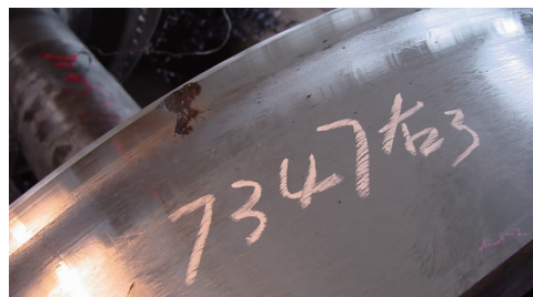
图2 轮缘裂纹底部呈现出来的裂纹源
