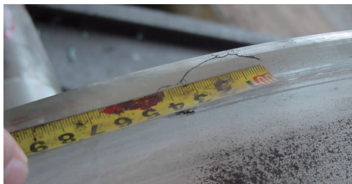
图1 车轮在检修过程暴露出来的轮缘裂纹
