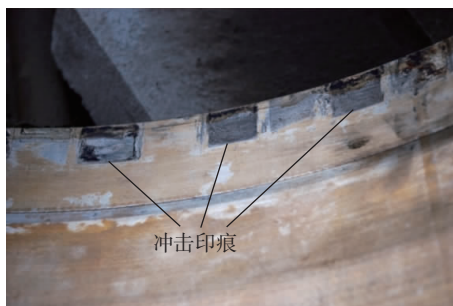
图2 护环结合部位冲击印痕
