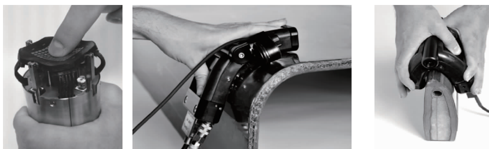
(a) 柔性相控阵换能器 (b) 柔性换能器检测复合材料罩体 (c) 柔性换能器检测直升机叶片
