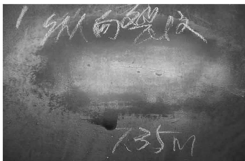
图 2 轴向裂纹(距端头 7.35 m 处)
