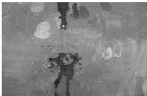
图 3 1 m 处点腐蚀( \phi 10 \text{ mm} \times 2.5 \text{ mm} )
