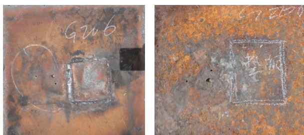
(a) 割板正面 (b) 割板底面(与基础接触面)
