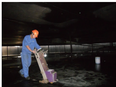
图 2 外浮顶储罐底板漏磁检测
