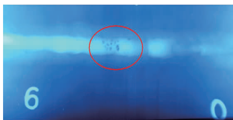
图 11 缺陷 9 密集气孔射线底片
