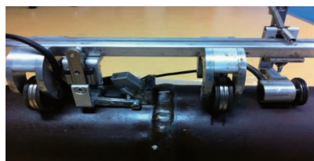
图6 管道相控阵超声检测扫查装置
