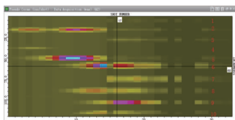
图3 右侧扫查对接焊缝中 不同位置缺陷的C扫描图
