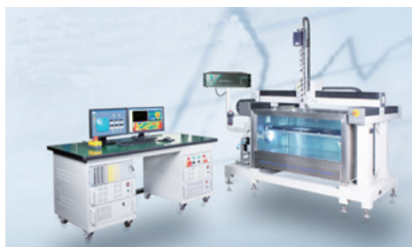
图 1 全自动盘环件水浸超声检测系统
