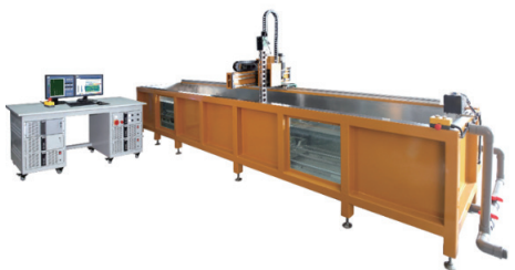
图 3 全自动棒材水浸超声检测系统
