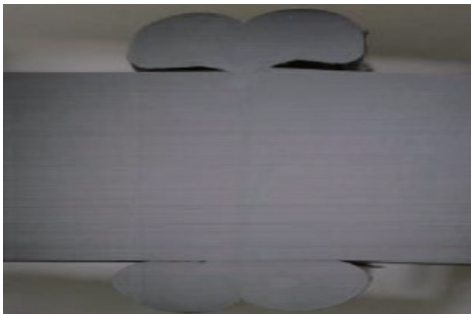
图 2 热熔焊缝结构示意图
