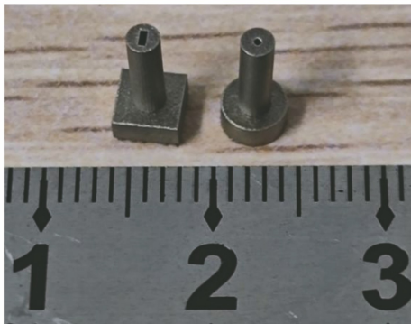
图 4 体积型缺陷模拟试件及裂纹缺陷模拟试件实物 分辨力小于 1\text{ }\mu\text{m} , 测量精度可以达到 4 + L/100\text{ }\mu\text{m} 。探测器为平面探测器, 其尺寸(长 \times 宽)为 400\text{ mm}\times 400\text{ mm} , 探元数量为 2\text{ }000\times 2\text{ }000 , 单个像素尺寸为 200\text{ }\mu\text{m} 。
