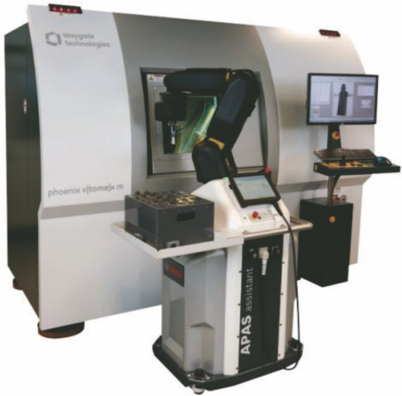
图 5 Phoenix v|tome|x m 高分辨 CT 设备实物
