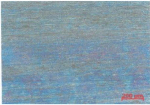
图 9 封严齿第四齿表面金相检验结果(200×)
