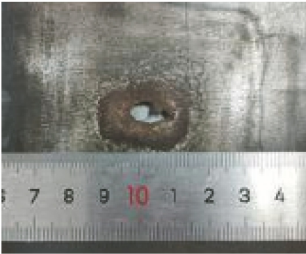
图 4 腐蚀后钢板的表面形貌
