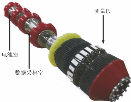
图 5 漏磁检测内部探测器结构
