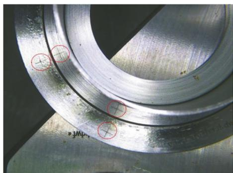
图11 锁紧杯模拟缺陷试块测试
